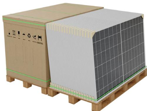
4. 扶组件的两人轻推组件，使组件缓慢斜靠在支撑物上，待组件完全倚靠在支撑物上时，在短边剪断剩下横向打包带，然后从最外侧开始依次移开所有组件；
