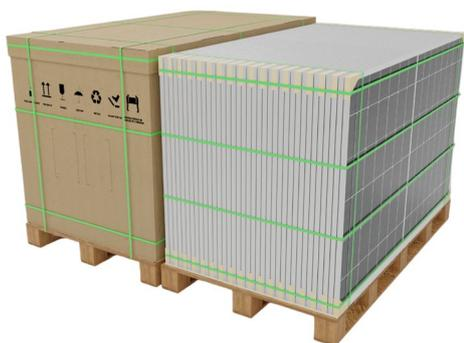
4. 移除纸箱上盖，上提纸箱移除箱筒；两人扶住组件，防止组件倾倒；另一人剪断竖向打包带和横向中上方打包带，保留横向最下方1根打包带；
