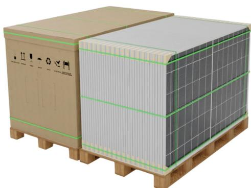
3. 移除纸箱上盖，并上提纸箱移除围卡箱筒；两人扶住组件，防止组件倾倒；另一人剪断竖向打包带和横向中上方打包带，保留横向最下方1根打包带；
